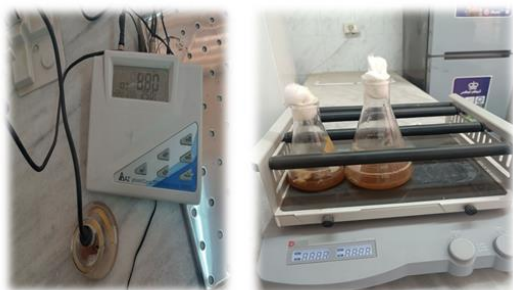
Wêneya 12: Çareseriya agarê ya ku argînin û probiyotîkan li ser shaker û pH metreyê ji bo pîvandina pH-ê dihevine
