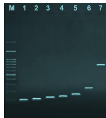
Wêneya 13: Gela elektrofores a hilberên PCR, Lane M, Ladder DNA. Rêça 1, L. paracasei . Rêça 2, L. casei . Rêça 3, L. fermentum . Rêça 4, L. rhamnosus . Rêça 5, L. reuteri . Rêça 6, L. brevis . Rêça 7, L. acidophilus
